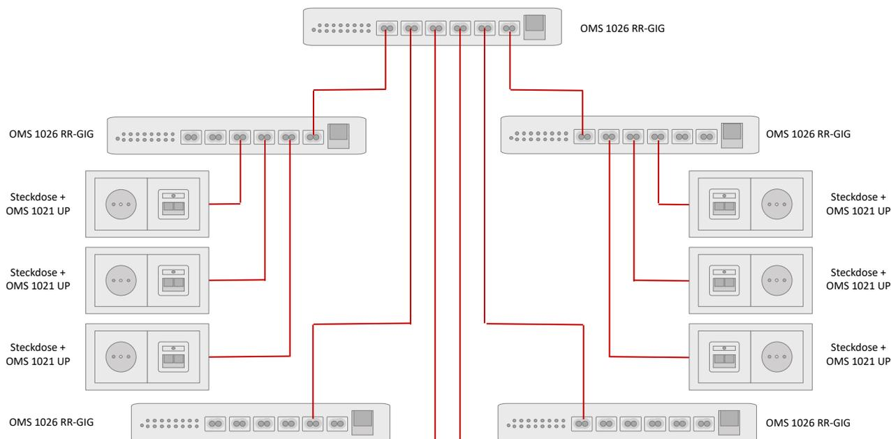
In Bürogebäuden, Schulen oder Hotels ist ein Switch meistens nicht ausreichend, da viele weitere Anschlüsse benötigt werden. Die Switches von Homefibre können kaskadiert werden um die Systemarchitektur zu erweitern und den örtlichen Gegebenheiten optimal anzupassen (z.B. durch Kaskadierung der Switches in Stockwerken etc...).
