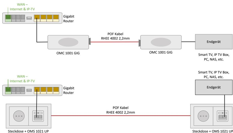
Im ersten Szenario wird eine einfache Punkt zu Punkt Verbindung mit dem OMC 1001 GIG PoF Medienkonverter Set zwischen Computer und Router hergestellt. Somit kann eine Internetverbindung für den Computer bereit gestellt werden.
