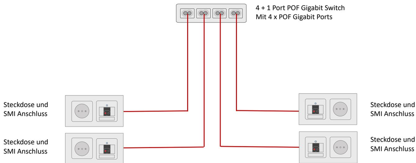
Um für die Zukunft Netzwerk Anschlüsse nachrüstbar zu machen ist es auch möglich eine passive Vorinstallation durchzuführen. Sie bietet die Möglichkeit, flexibel ein Netzwerk zu installieren und nach Bedarf zu erweitern.
