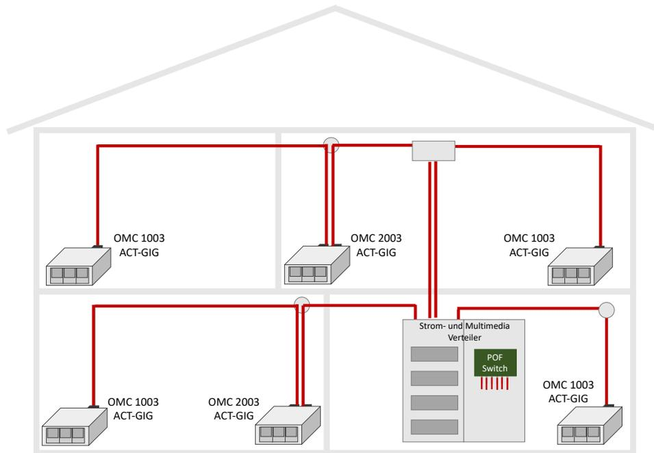
Diese Geräte bieten die Möglichkeit, mehrere Geräte gleichzeitig in ein POF Netzwerk zu integrieren. Die Anschlüsse sind wie bei einem typischen Switch untereinander verschaltet.
