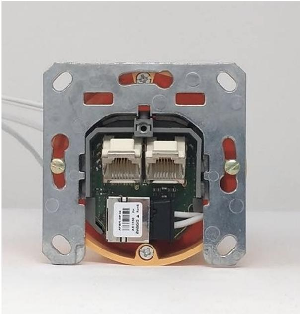
Die Netzwerkdoesen sind Unterputz Switches mit zwei RJ45 Anschlüssen um vernetzte Geräte verkabelt ins Netzwerk zu integrieren. Sie verfügen auch über eine integrierte Medienkonverter Funktion, damit Netzwerk Geräte über herkömmliche Kupfersignale mit dem optischen Netzwerk kommunizieren können.
