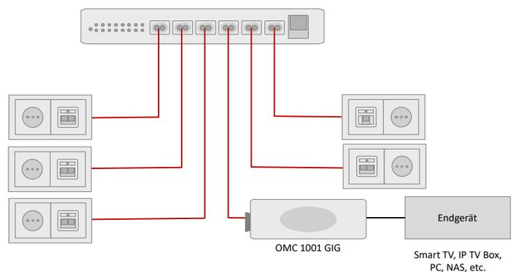
Mit Hilfe eines Medienkonverter wird eine Verbindung zwischen einem POF Switch und einem Netzwerk Gerät aufgebaut.
