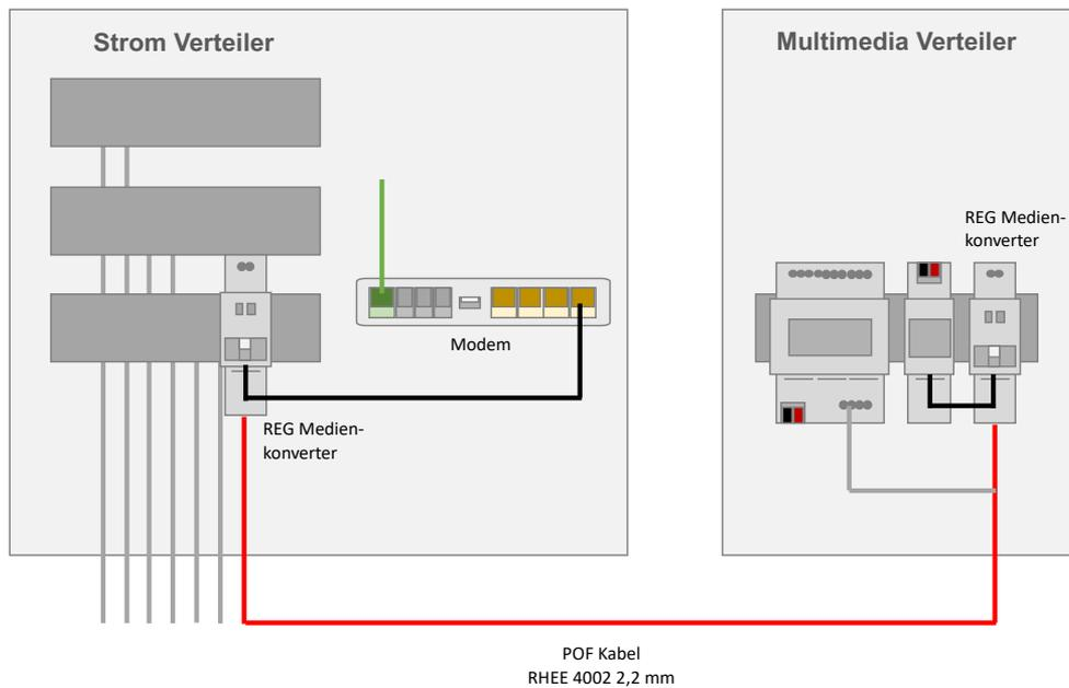
Für Smart Home Anwendungen oder für die Kombination mit der Elektroinstallation werden bevorzugt Medienkonverter für die Hutschienen Montage eingesetzt.
