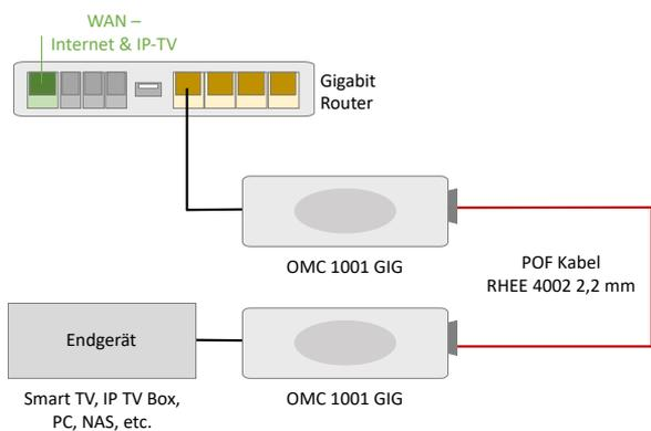
Mit einem Medienkonverter Set wird hier ein Endgerät an den Router angeschlossen. Das nur 2,2mm dünne Kabel erlaubt ein Verlegen mit Elektroinstallationen oder entlang von Fußleisten / unter Teppichen.
