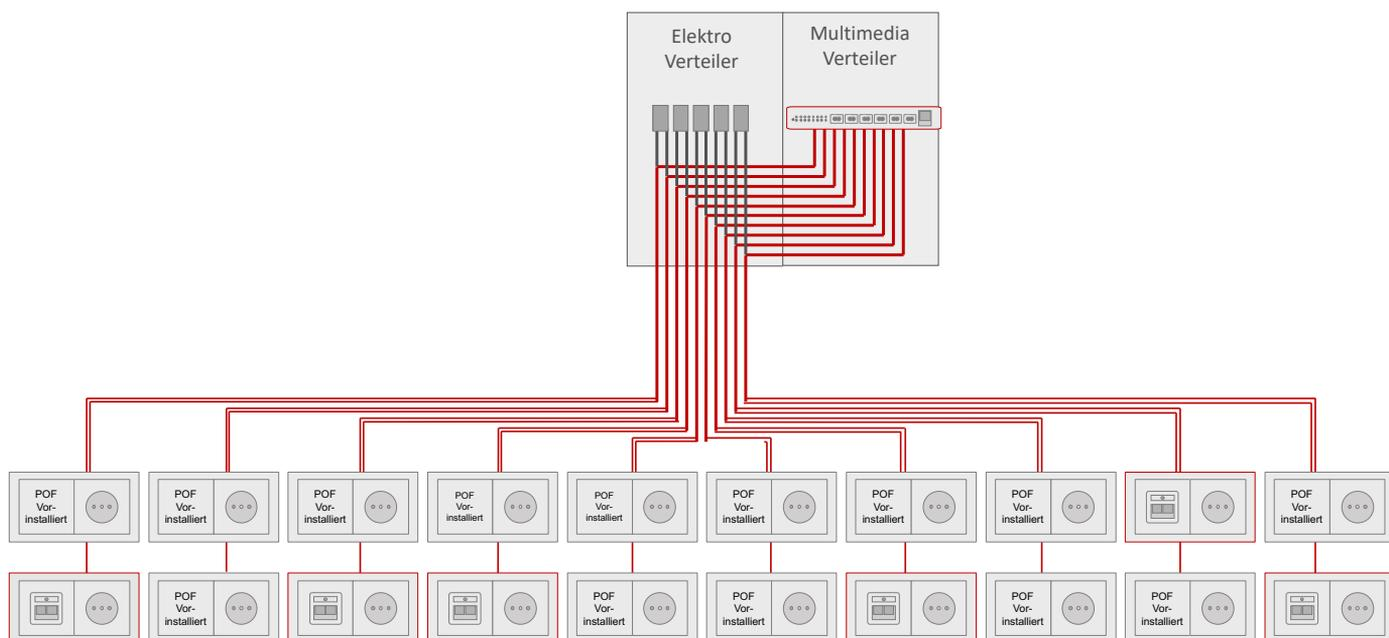
Diese erweiterte Netzwerk Architektur zeigt mehrere Stromanschlüsse mit vor-installiertem POF Kabel. Manche davon sind bereits mit einem Unterputz Switch oder einem Unterputz WLAN Zugangspunkt ausgestattet.
