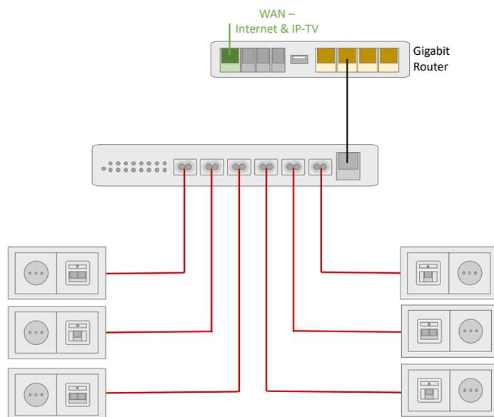
In diesem Beispiel wird eine typische PoF Heimnetzwerk Lösung mit sechs sternverkabelten Verbindungen dargestellt. Die entwickelten Gigabit Netzwerkdosen (OMS 1021 UP-GIG), 100 Mbit/s Netzwerkdosen (OMS 1021 UP) und die WLAN Zugangspunkte (OMA 111 A2 WLAN) können je nach Bedarf eingesetzt und kombiniert werden. Alle Komponenten sind untereinander kompatibel.
