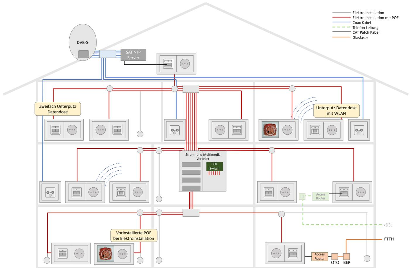
Diese Skizze zeigt ein Haus mit kombinierter POF-Elektroinstallation. Ein Grossteil der Stromsteckdosen wird mit einer POF-Leitung verkabelt. Dies geschieht in Kombination mit der Elektroinstallation. Damit werden in jedem Raum mehrere Datenauslässe vorinstalliert. Trotz geringerer Installationskosten für die Breitband-Verkabelung wird die Anzahl der Netzwerkanschlüsse um ein mehrfaches erhöht. Ein echter Mehrwert!
