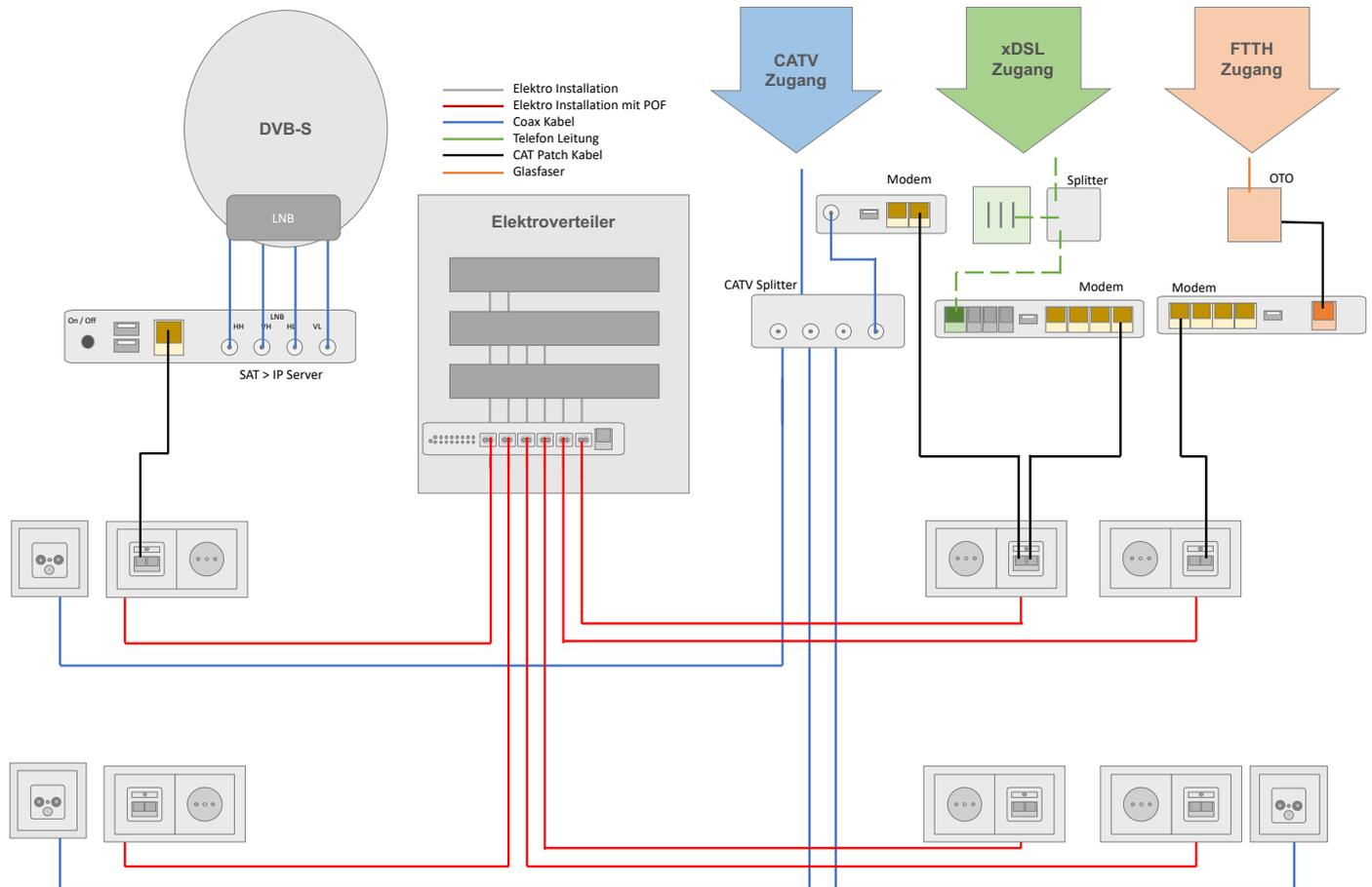
Ein POF-Netzwerk wird wie eine strukturierte Verkabelung installiert. Das optische Kernnetzwerk bietet jedoch mehr und vor allem neue Möglichkeiten eine innovative Netzwerkinfrastruktur zu realisieren. In Kombination mit der Elektroinstallation wird es zum Daten-Backbone für alle IP Anwendungen. Es ergibt sich dann eventuell eine Stern-Baum Struktur in der überall im Haus, je nach Bedarf, neue Netzwerkanwendungen und neue Services integriert werden.
