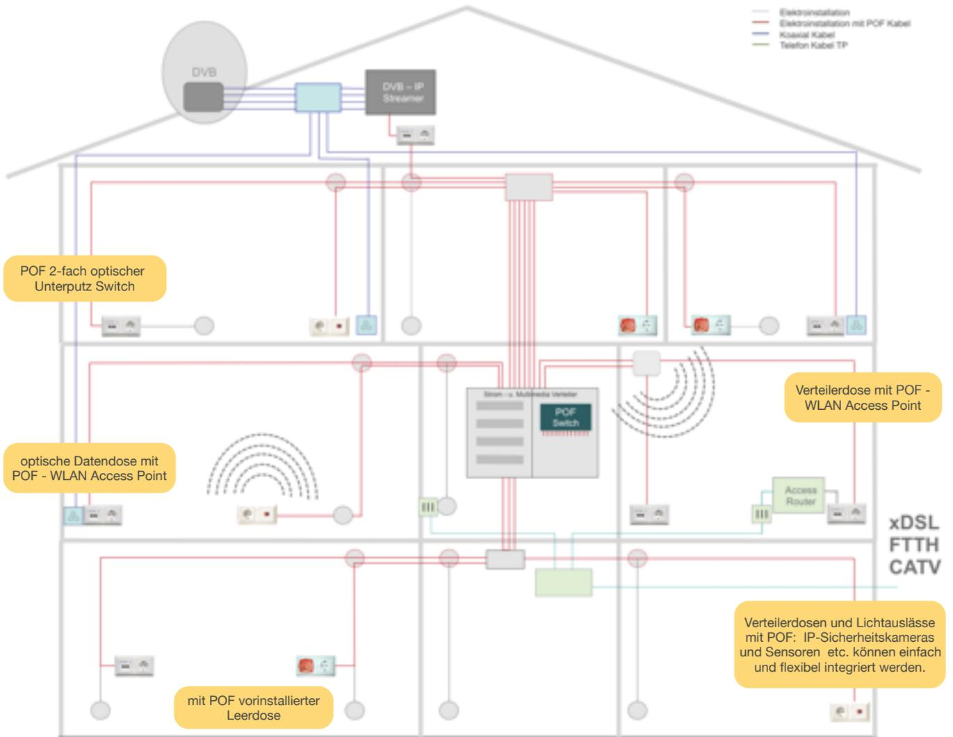
**Die zukunftsorientierte Installation eines Hauses** oder einer Wohnung mit einem optischen POF Daten-Backbone bietet ein Maximum an Integrationsmöglichkeit für unterschiedliche Geräte und Dienste. Über das IP-basierte Netzwerk werden Haussteuerung, Sicherheitsanwendungen, Multimediageräte und Services übertragen. Das mit der Elektroverdrahtung vorinstallierte optische Kabel
