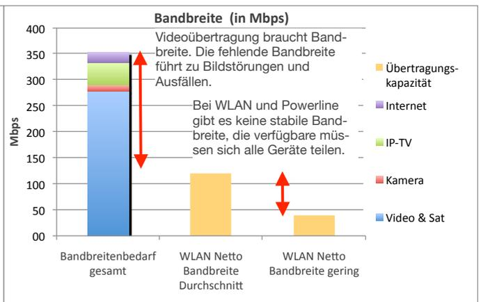
alle Geräte eine relativ begrenzte Bandbreite. Auf Grund der elektromagnetischen Störanfälligkeit dieser Systeme ändert sich die Bandbreite. Eine sichere Übertragung mehrerer hochwertiger Videoprogramme kann z.B. nicht garantiert werden. Die elektromagnetische Strahlung (EMS) ist meist relativ hoch. (2)
