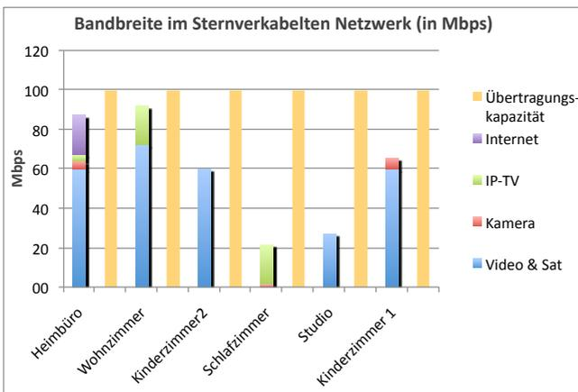
In einem Heimnetzwerk mit sternförmiger Verkabelung hat jeder Raum oder jede Steckdose die volle Bandbreite von z.B. mind. 100Mbps oder 1 Gbps zur Verfügung. Damit ist eine sichere Übertragung digitaler Video- und Audiodaten gewährleistet. Die Übertragung über Lichtwellenleiter verursacht zudem keine elektromagnetische Strahlung (EMS). In einem drahtlosen (Wireless) Heimnetzwerk teilen sich
