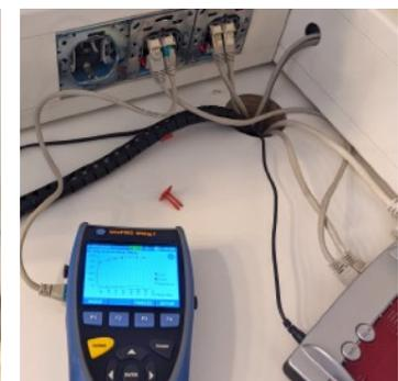
Per ogni connessione, le prestazioni di trasmissione dei dati sono state misurate utilizzando il test RFC 2544.
