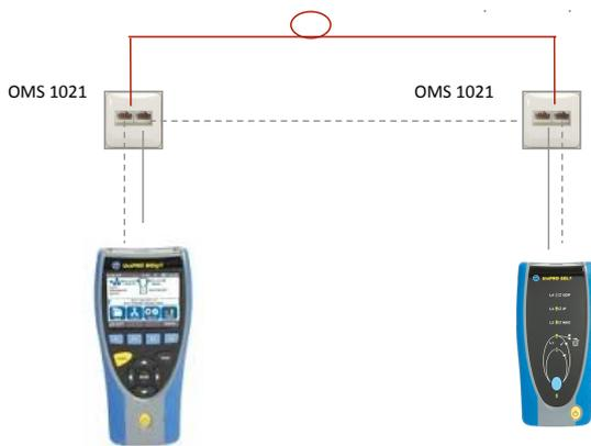
Testaufbau für RFC2544 und SLA-Tick Test
