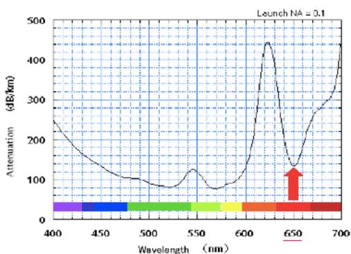
Für das Homefibre System wird eine Wellenlänge von 650nm verwendet. In diesem Bereich hat die POF Faser eine minimale optische Dämpfung. In Zukunft könnten auch die optischen Fenster blau, grün und gelb genutzt werden.
