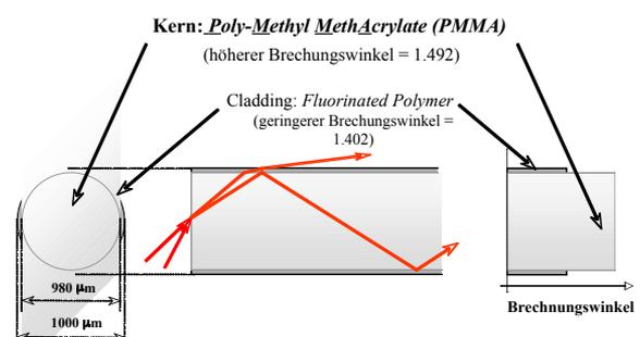
Die POF Faser ist eine Multimode Faser. Das Licht wird an der Faserhülle (Cladding) reflektiert und im PMMA Kern übertragen. Der große Kerndurchmesser von 1mm begünstigt die einfache Anschluss-technologie.
