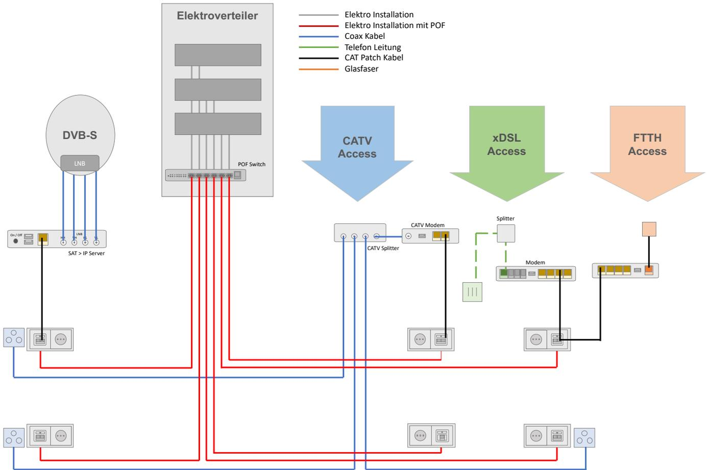
Ein POF-Netzwerk wird wie eine strukturierte Verkabelung installiert. Das optische Kernnetzwerk bietet jedoch mehr und vor allem neue Möglichkeiten eine innovative Netzwerkinfrastruktur zu realisieren. In Kombination mit der Elektroinstallation wird es zum Daten-Backbone für alle IP Anwendungen. Es ergibt sich dann eventuell eine Stern-Baum Struktur in der überall im Haus, je nach Bedarf, neue Netzwerkanwendungen und neue Services integriert werden.
