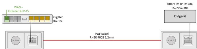
Es besteht jedoch genau so die Möglichkeit, eine Punkt zu Punkt Verbindung zwischen den Netzwerkdosen OMS 1021 UP-GIG oder OMS 121 UP aufzubauen.
